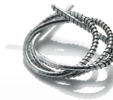
vorher Spanbildung mit herkömmlicher Bearbeitung
