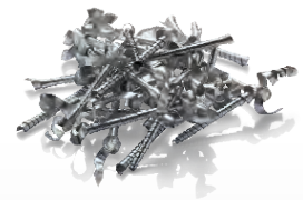
nachher Spanbildung mit High-Frequency-Turning
