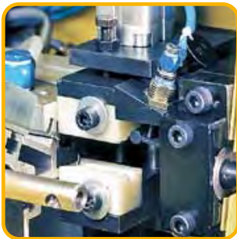
Die Führungslinette ermöglicht die Verarbeitung von Rund- und Profilmaterial
